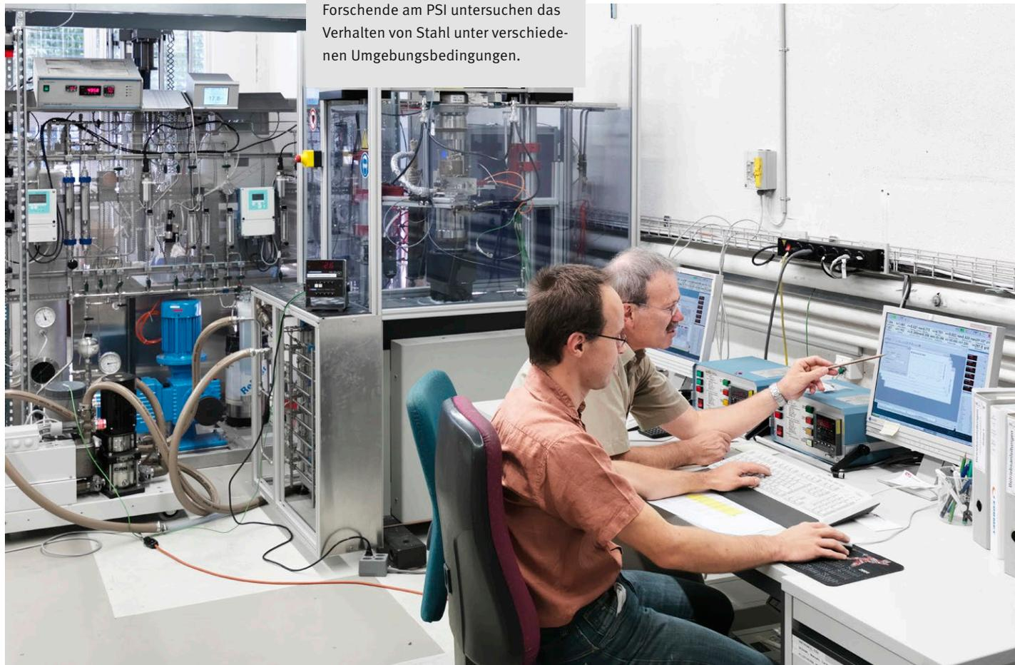
Mit dieser Anlage wird Stahl bei Verhältnissen geprüft, wie sie im Kernkraftwerk vorkommen. Die Resultate fließen in mathematische Modelle ein, mit denen die Sicherheit und damit die Lebensdauer der Kernanlagen eingeschätzt werden kann.
