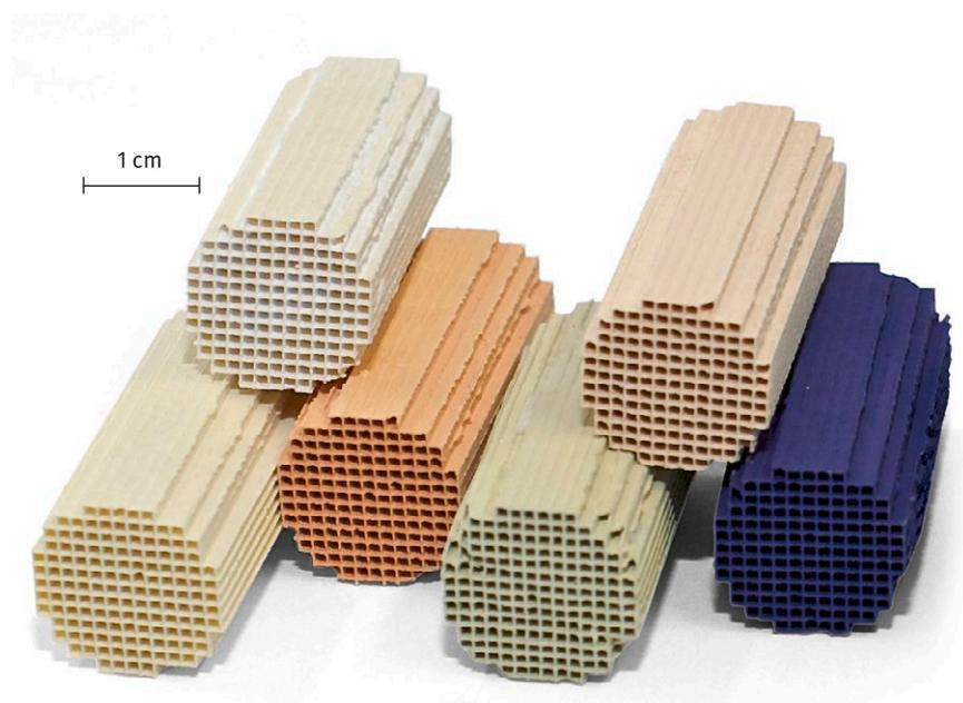
Unterschiedliche Katalysatoren beschichtet auf keramischen Wabenkörpern (ganz links unbeschichtet). Je nach chemischer Zusammensetzung des Katalysators variiert die Farbe.
