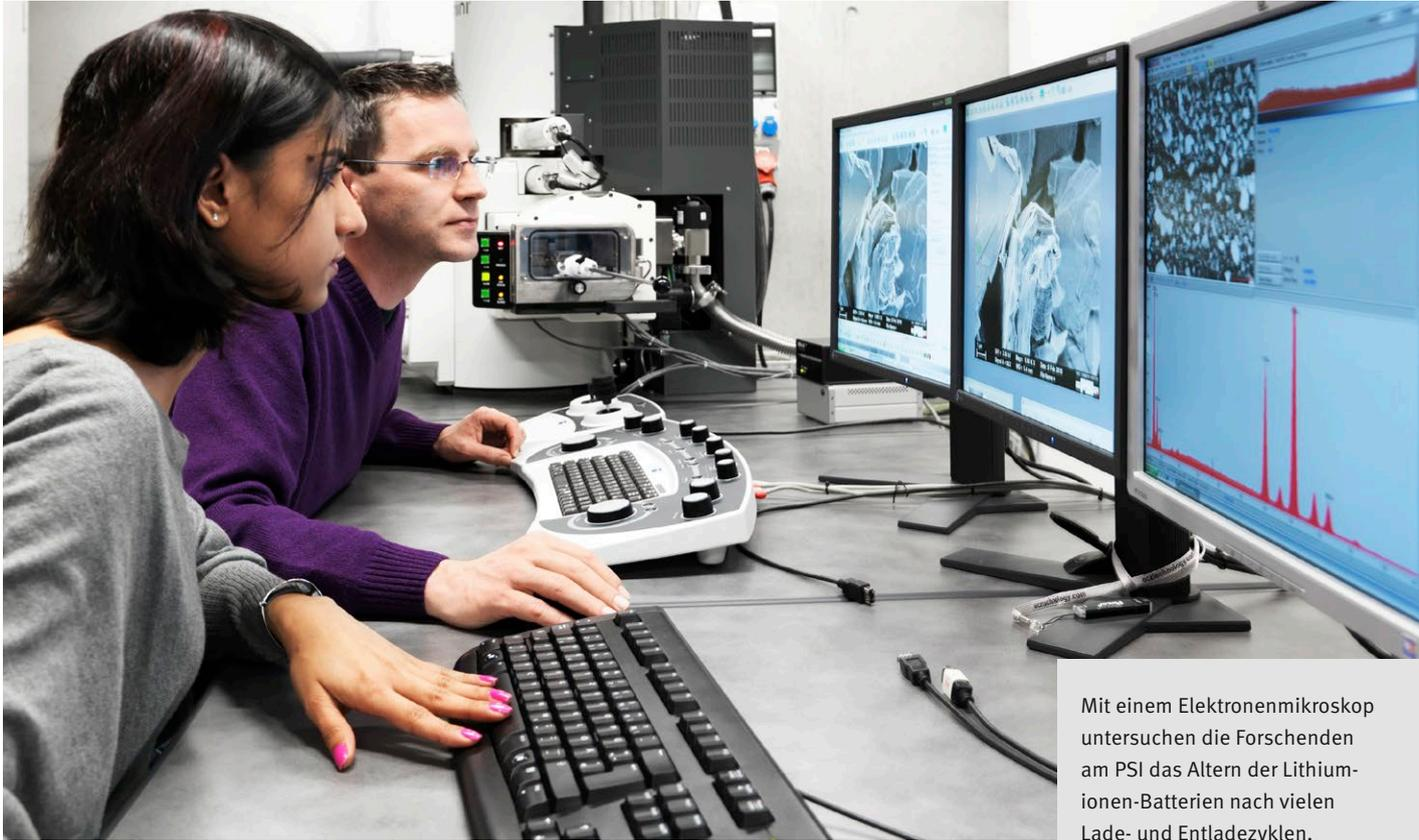
Mit einem Elektronenmikroskop untersuchen die Forschenden am PSI das Altern der Lithiumionen-Batterien nach vielen Lade- und Entladezyklen.
