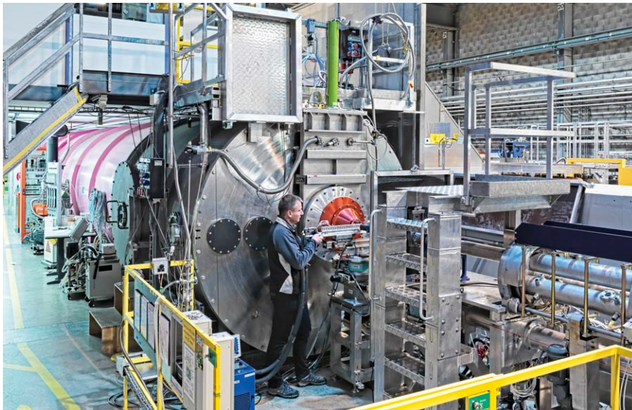
Instrumenten-Betreuer Joachim Kohlbrecher am SANS-I-Messplatz an der SINQ. Dort werden Proben mit Neutronenstreuung untersucht.
