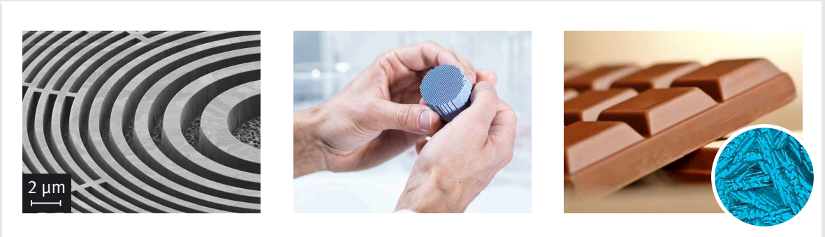
Diamantschicht mit lithografischem Verfahren mikrostrukturiert (links). Untersuchung und Entwicklung von Katalysatoren (Mitte). Untersuchung von Eis- und Zucker-Kristallisationsprozessen in Lebensmitteln (rechts).
