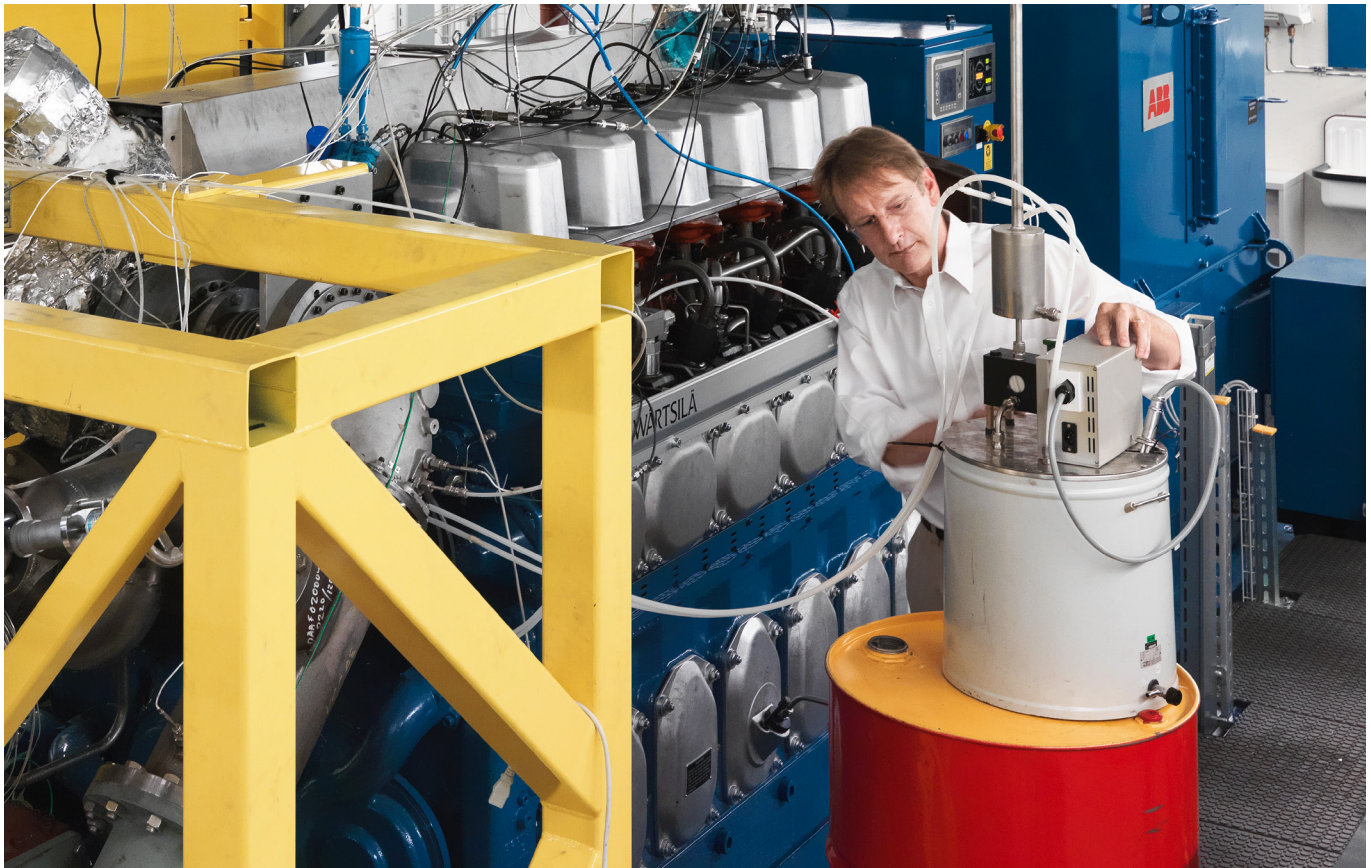
Klaus Hoyer optimiert am Schiffsdieselmotorenstand des PSI die Technologie von Schiffsmotoren. Ziel ist den Stickoxidausstoß stark zu verringern.
