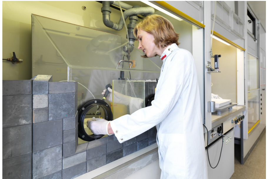
Die Mauer aus Bleibarren schirmt Cristina Müller von den radioaktiven Substanzen ab, mit denen sie unter der Lüftungshaube hantiert.
