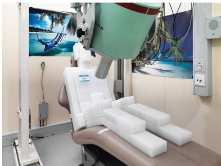
Das «personenähnliche Phantom» IGOR dient zur Kalibrierung des Ganzkörperzählers. Mit diesem empfindlichen Detektor kann festgestellt werden, ob radioaktive Substanzen in den Körper aufgenommen wurden.
