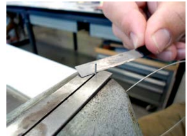
Bild 1: Mantel-Thermoelement \varnothing 1.5mm mit Säge abisolieren
