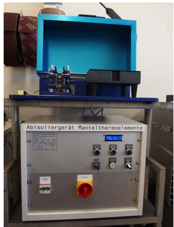
Bild 2: Abisoliergerät bei der Fachgruppe «Fügetechnik und Sensorik» in Betrieb
