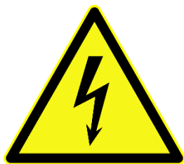
Abbildung 6-3 Warnsymbol bei Hochvolt-Kennzeichnung von elektrischen Fahrzeugen
