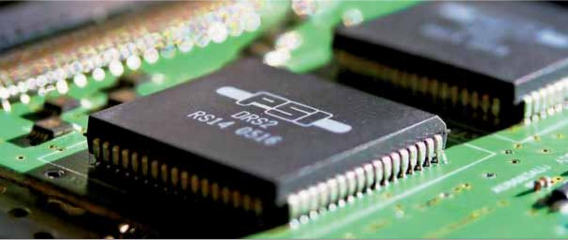
Fünf Milliarden Messungen pro Sekunde: Der DRS-Chip hat auf einer Fläche von fünf mal fünf Millimeter mehr als 300 000 Transistoren.
