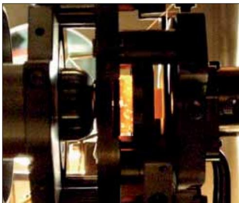
Blick in die Ionenquelle der BioMICADAS-Anlage: Bis 250 Messproben können hier pro Tag untersucht werden.
