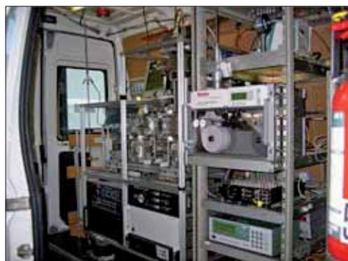
Das PSI-Messmobil ist für Feinstaubmessungen mit modernsten Instrumenten ausgerüstet.
