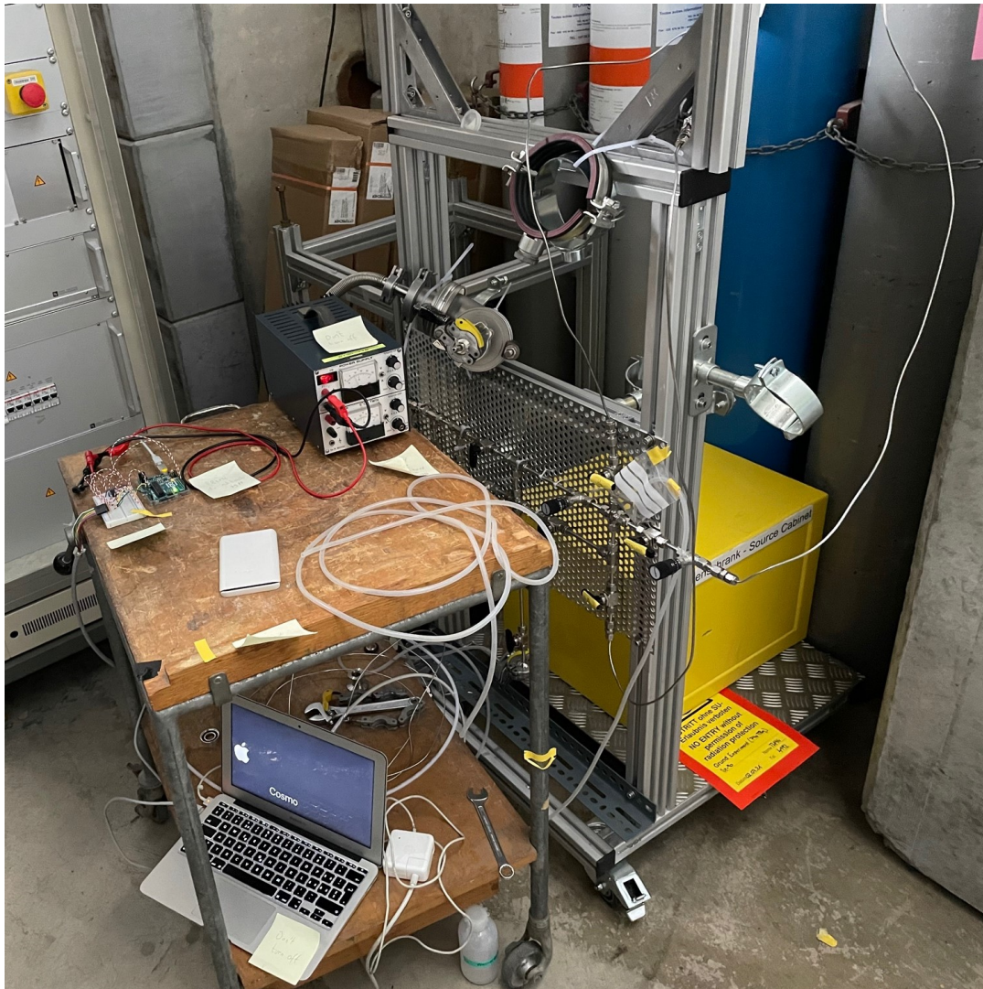
Figure 38: Links sieht man den verstellbaren Tisch, welcher für die nächsten Versuche gebraucht wurde. Links auf dem Tisch wurde die Spannungsquelle positioniert. Rechts sieht man den Arduino und das Steckbrett. Der Laptop zur Datenerfassung und Stromversorgung des Arduinos wurde unter der Tischplatte platziert. Rechts vom Tisch sieht man das Gestell mit den Ventilen zur Heliumversorgung. Hinter dem Gerüst befand sich der Quellensafe für den späteren Versuch (gelbe Box). Im Hintergrund sieht man die Heliumflaschen. Quelle: eigene Darstellung.
