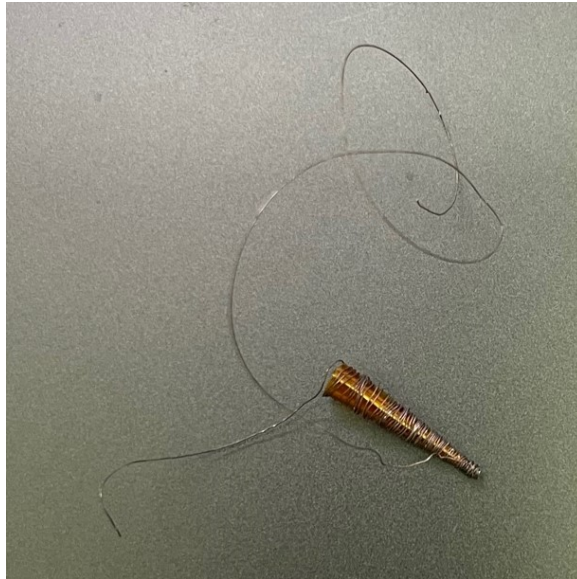
Figure 32: Eine Heizung, welche einen gewickelten Kaptonstreifen enthält. Quelle: eigene Darstellung.
