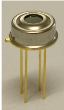
Figure 13: Der benutzte Infrarotsensor MLX 90614. Über das obige Fenster wird die Temperatur gemessen. Die vier Beinchen sind die Anschlüsse (Verweis auf Text für genauere Erklärung). Da diese nicht angeschrieben sind, ist die kleine Ausbuchtung links vorhanden. Mit diese ist es möglich die Orientierung festzustellen (Fig. 15). Quelle: [21].
