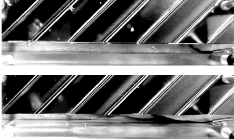
Abb. 3.9 Farbeindüsung in den Spalt in Höhe des Fluideintrittes bei Re_{d_{hy}} \approx 600 (neuentwickelte Struktur oben, offene Packung unten)
