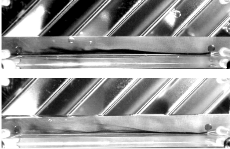
Abb. 3.11 Farbeindüsung in verbreiterten Spalt in Höhe des Fluideintrittes bei Re_{dhy} \approx 330 (neuentwickelte Struktur oben, offene Packung unten)
