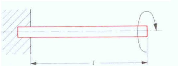
Anregung eines einseitig eingespannten Stabes zu einer Torsionsschwingung durch Ausüben eines Drehmomentes um die Stabachse.
